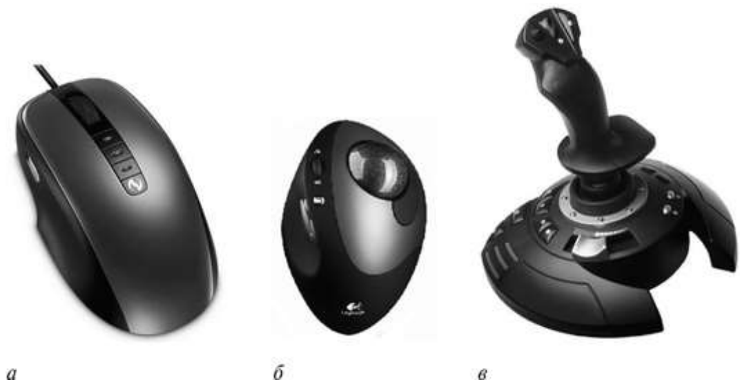
Рис. 2.27. Манипуляторы: а - мышь; б - трекбол; в - джойстик
