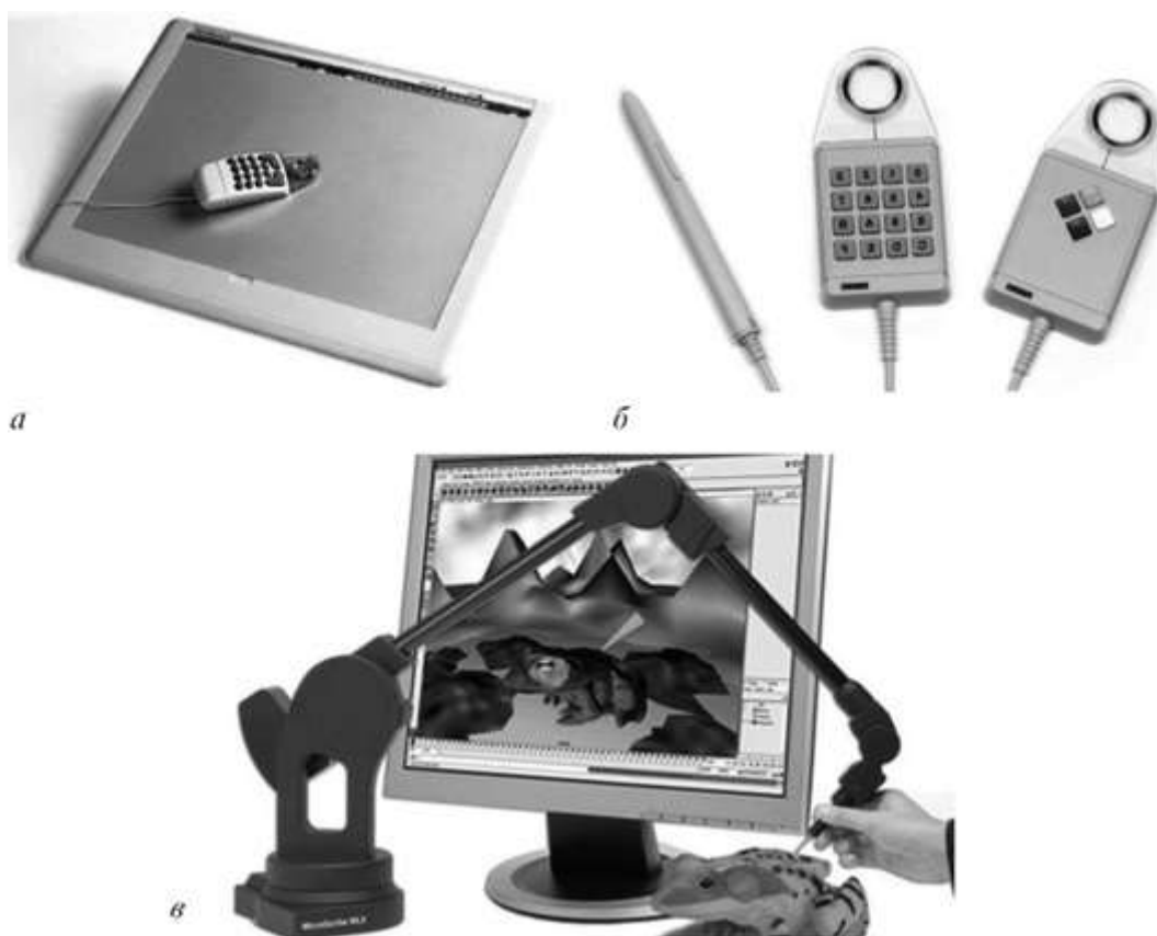
Рис. 2.29. Дигитайзер: а - планшет; б - карандаш и визиры; в - 3D-дигитайзер
