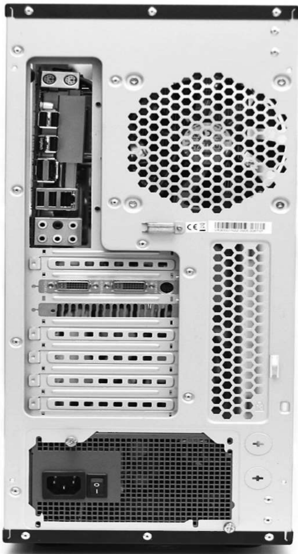
Рис. 2.19. Расположение портов на обратной стороне системного блока ПК
