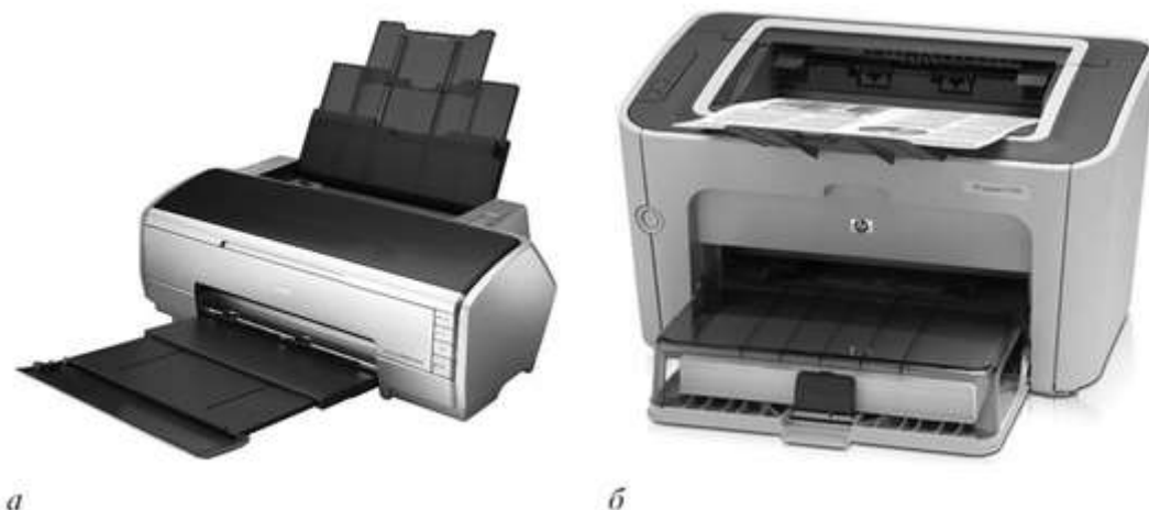
Рис. 2.32. Принтер: а - струйный; б - лазерный
